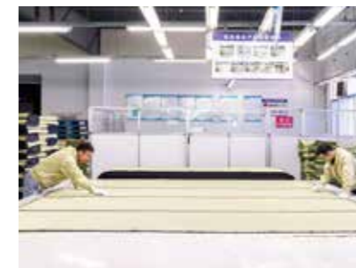
製織された製品は、一枚一枚織り傷がないかなどをチェックする仕上げを行う。
