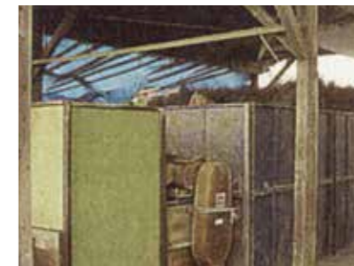
①天日乾燥...泥染めされたい草を刈り取り後の田に並べて太陽光により約2日間かけて乾燥させる。②火力乾燥...泥染めされたい草を火力により約12~13時間かけて乾燥させる。
