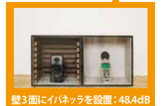
壁3面にイバネッタを設置: 48.4dB
